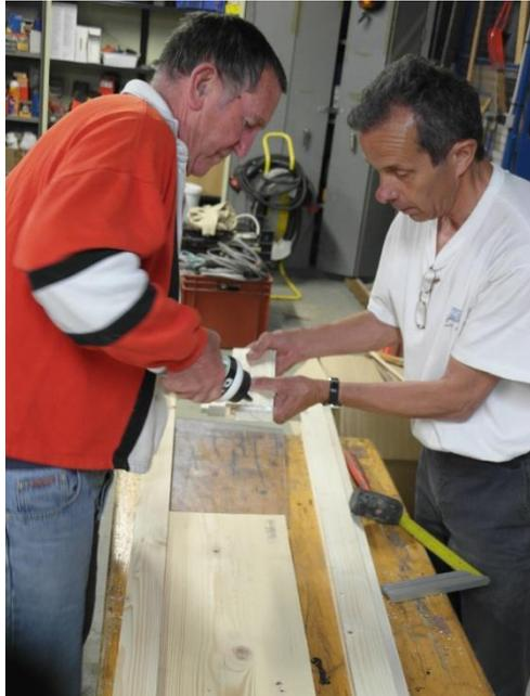
Comme prévu, l'essentiel du mois de Mai a été consacré aux portes des faces avant et arrière, qui ne sont pas identiques. Ce sont des applications typiques de menuiserie, cadres avec rainure des montants, assemblage par languettes et chevillage final.
